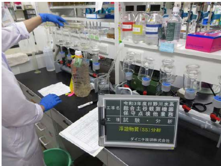
土砂濃度の計測(SS分析)
